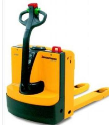
При работе в несколько смен замену батареи можно производить сбоку (опция). Длинная рукоять управления гарантирует безопасную работу, обеспечивая комфортное расстояние между оператором и тележкой. А в особо узких местах клавиша замедленного хода позволяет осуществлять безопасное перемещение тележки с вертикально поднятой рукоятью. Достаточно одного нажатия на клавишу – и тормоз разблокируется, а за счет управления переключателем движения тележка движется с автоматически уменьшенной скоростью.
